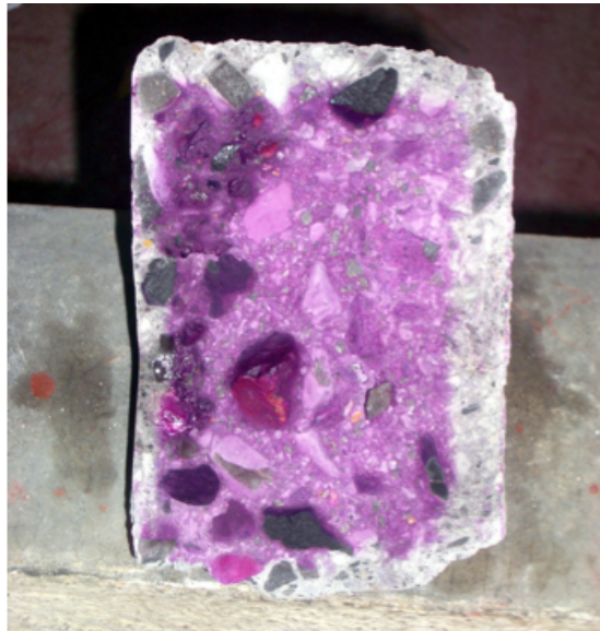
Fig. 5: medida del espesor de carbonatación por exposición natural.
