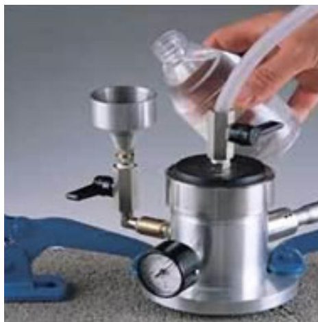
Fig. 6: Dispositivo comercial para ensayo ISAT.
