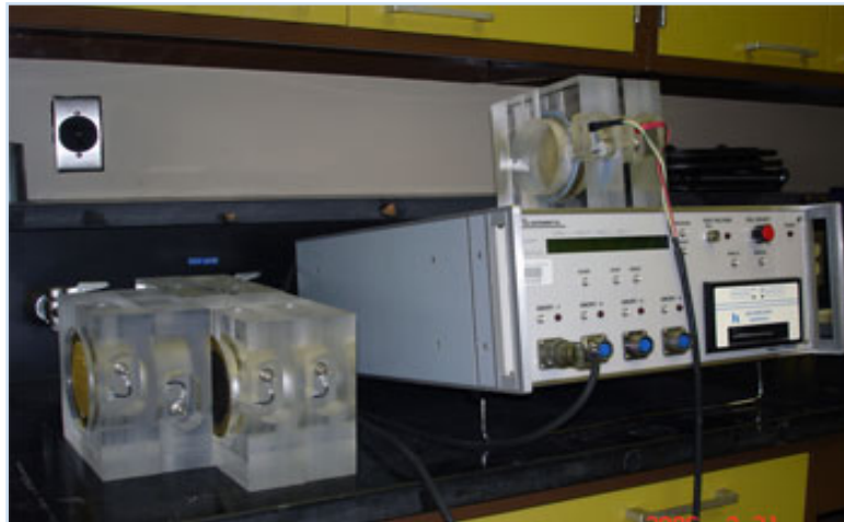
Fig. 11: Equipo disponible comercialmente para el ensayo según ASTM C 1202
